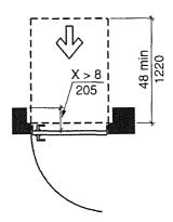
FIGURE 404.2.3.5(E) RECESSED DOORS AND GATES - EXISTING BUILDINGS PUSH SIDE
