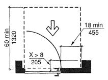
FIGURE 404.2.3.5(D) RECESSED DOORS AND GATES - EXISTING BUILDINGS PULL SIDE
