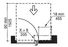
FIGURE 404.2.3.5(A) RECESSED DOORS AND GATES - NEW BUILDINGS PULL SIDE
