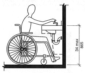
**FIGURE 606.3 HEIGHT OF LAVATORIES AND SINKS**
